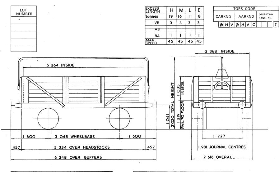
TARE -- 6 450kgBUFFERS - SPINDLE 330 DIA. HEADSCARRYING CAPACITY - 13000kgCOUPLINGS - INSTANTERCAPACITY - 12.827 m³MIN. CURVE - 21 mMAX. SPEED -45 mile/hGEN. ARRGT. DRG. No. - 16754 D, 16615 D, 16705 DWHEELS -939 DIA.BRAKE -VACUUM BLOCK & HAND LEVERJOURNALS - 228 x 108 PLAIN BEARINGSSUSPENSION - SHOE
