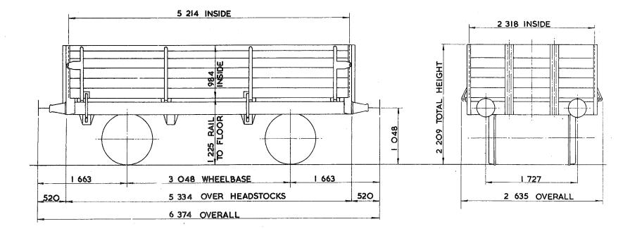
TARE - 6°50 kg CARRYING CAPACITY - 13 000 kg CAPACITY - 11. 892 m<sup>3</sup> MAX. SPEED - 45 mile/h WHEELS - 952 DIA.
