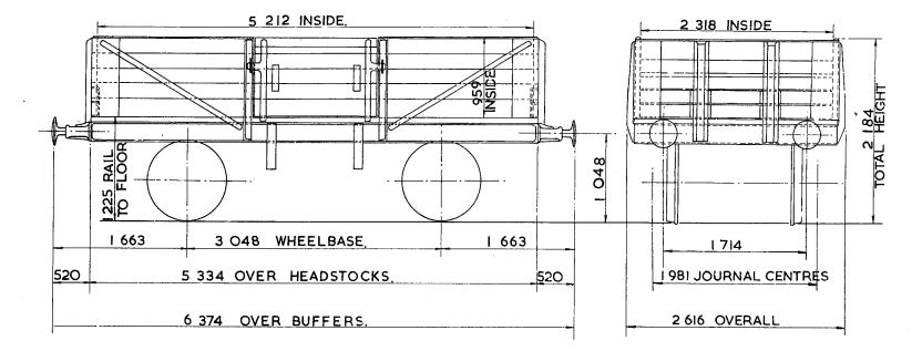
TARE-6650kgCARRYING CAPACITY - 13000kgCAPACITY -II.s88m³.MAX. SPEED - 45mile/h.WHEELS - 952DIA.JOURNALS - 228 × 108 PLAIN BEARING S.
