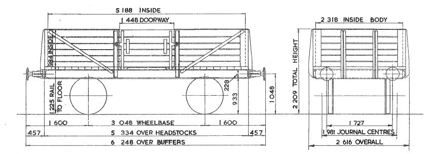
TARE-6 900 kg.BUFFERS-SICARRYINGCAPACITY-I3000 kg.COUPLINGS-CAPACITY-II.833 m³MIN. CURVE-MAX. SPEED-45 mHz/h.GEN. ARRGT. IWHEELS-952DIA.JOURNALS-228 x 108 PLAIN BEARINGSSUSPENSION
