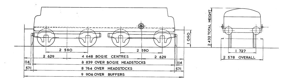
TARE -- 36 100 kg CARRYING CAPACITY CAPACITY --MAX. SPEED -- 60 mile / h WHEELS -- 1 092 DIA.
